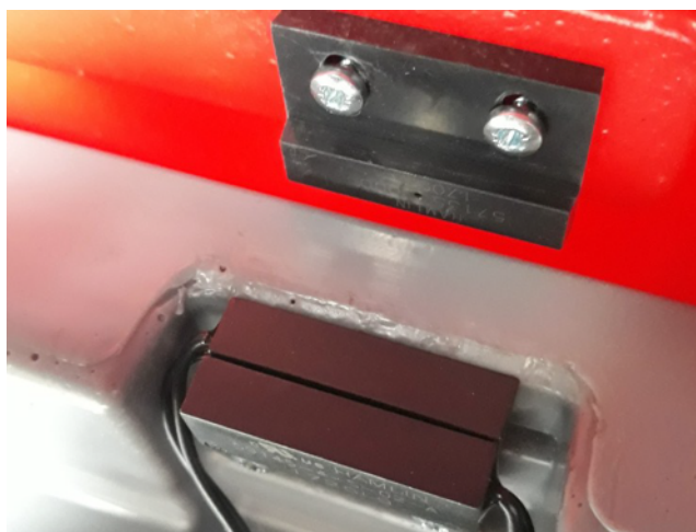
Abbildung 228: Positionierung der Magnete und der Reed-Relais
